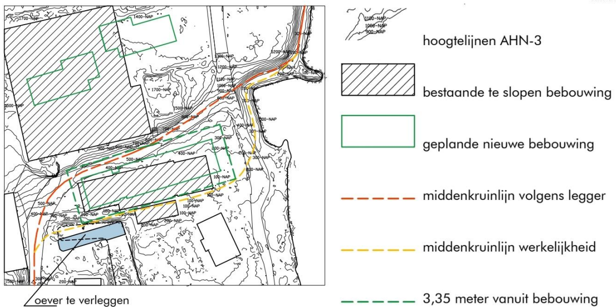
illustratie 5-4 Middenkruinlijn volgens Legger in vergelijking met werkelijk beloop. (bron: ir. wim klaassen - ARCHITECT)
