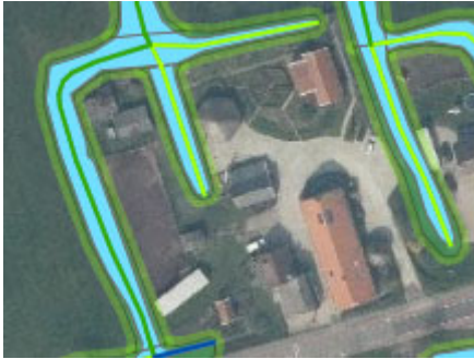
Figuur 4.3: Uitsnede Legger oppervlaktewateren. De beschermingszones zijn met groen aangegeven. Bron: Legger Hoogheemraadschap van Rijnland
