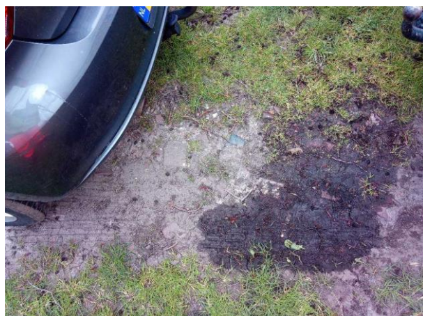
Fotonummer 4: Asbestverdacht plaatmateriaal op maaiveld
